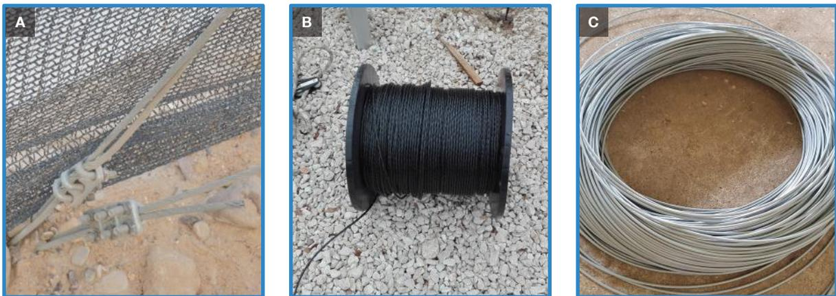
Figura 23. Tipos de cables. (A) acerados (B) fibra de carbono (C) poliamida.
