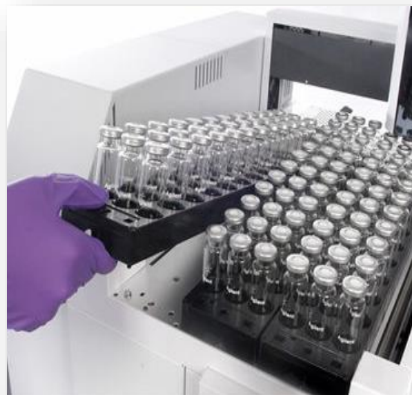
Figura 2. Automuestreador headspace 7697A con capacidad de analizar 111 muestras en un tiempo aproximado de 20 horas.
