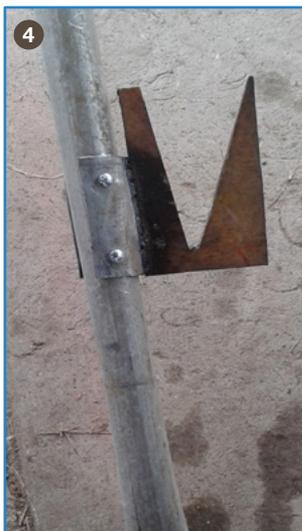
Figuras 3 y 4. Ejemplo de máquina cosechadora con platina móvil con tornillo de ajuste y con platina fija.
