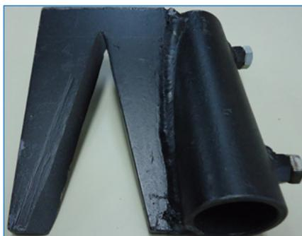
Figura 2. Hoja o platina metálica a la cual se le realiza un corte en forma de V.
