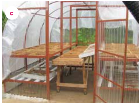
Figura 21. Diferentes modelos de secador tipo túnel con camas levantadas
