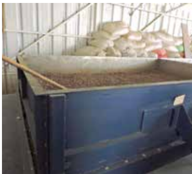
Figura 25. Secador artificial de cacao tipo Samoa
