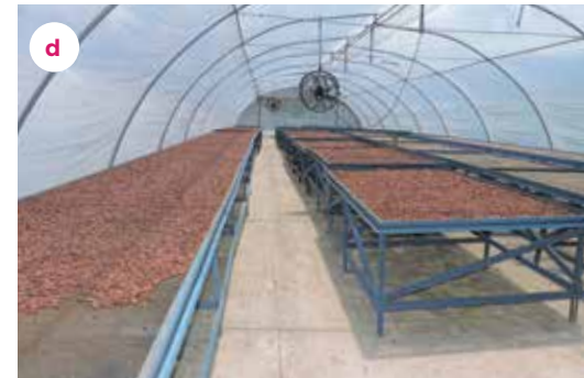
Figura 21. Diferentes modelos de secador tipo túnel con camas levantadas
