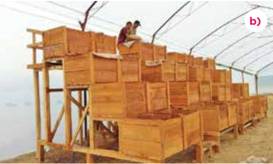
Figura 8. Sistema de fermentación en cajones: a) Cajones lineales sencillos (Finca CATIE, Turrialba) b) Cajones tipo escalera (Centro de acopio Nahua, Upala)
