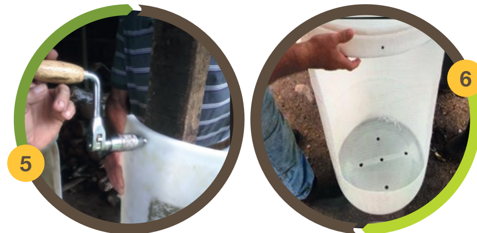
Figuras 5 y 6: Perforado de huecos en la puerta y en el fondo del estañón.
