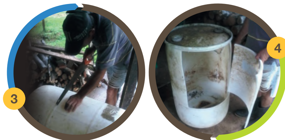
Figuras 3 y 4: Cortado del estañón para hacer puerta móvil.
