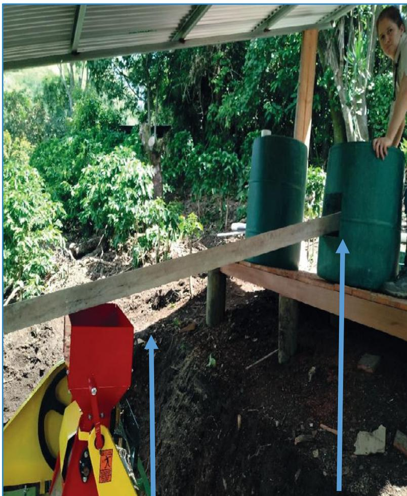
Figura 120. Los niveles son fundamentales para la circulación del agua y la fruta.
