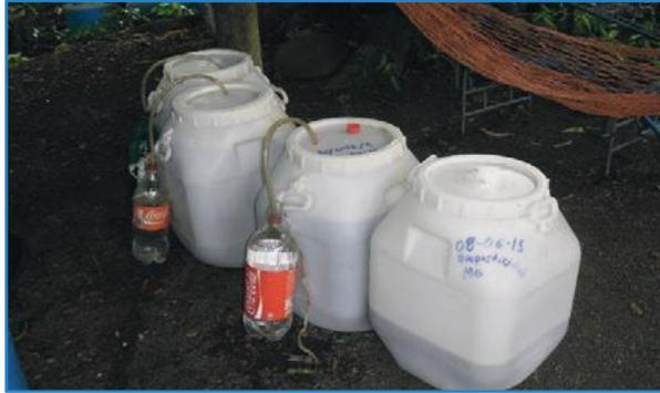
67a. Estañones con sus válvulas de seguridad
