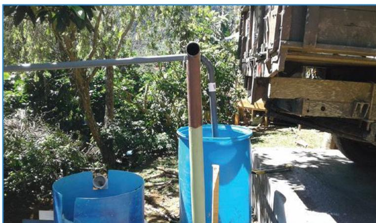
Figura 122. Sistema de rampa en sustitución de pila de recibo, la fruta pasa directamente a los estañones. Micro beneficio el Pílon (año 2016).
