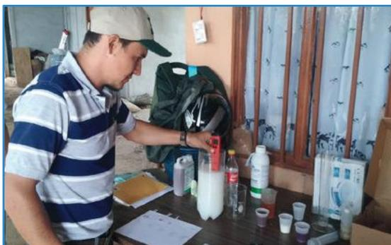
Figura 80. Evaluando el pH y el estado de las soluciones preparadas para aplicar en el campo. Hay que observar y medir lo que preparamos.
