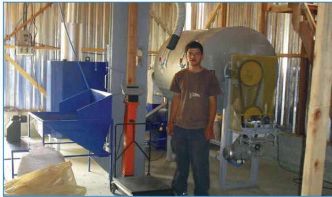
Figura 105. Sistema de secado mecánico (capacidad 10 quintales por bache)
