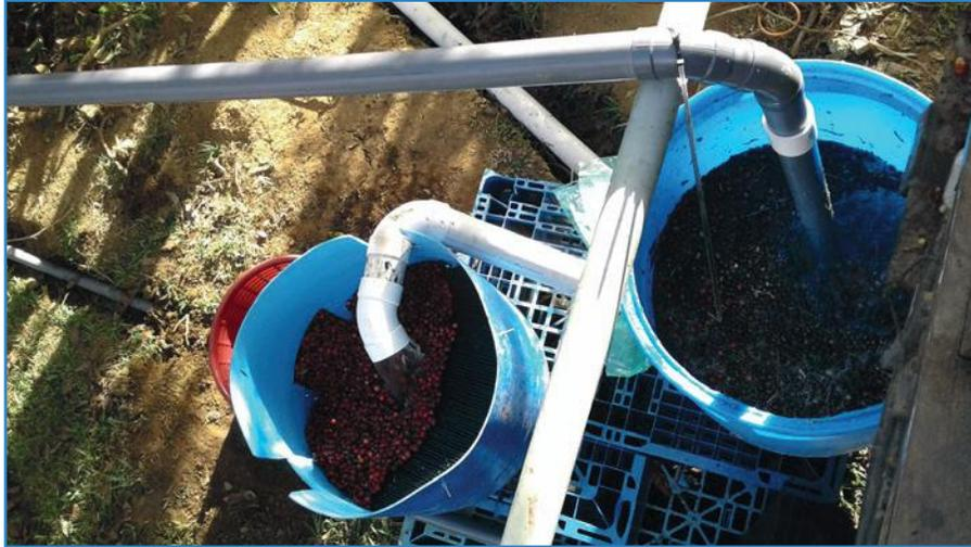
Figura 124. Sistema de separación de la fruta y el agua de recirculación.
