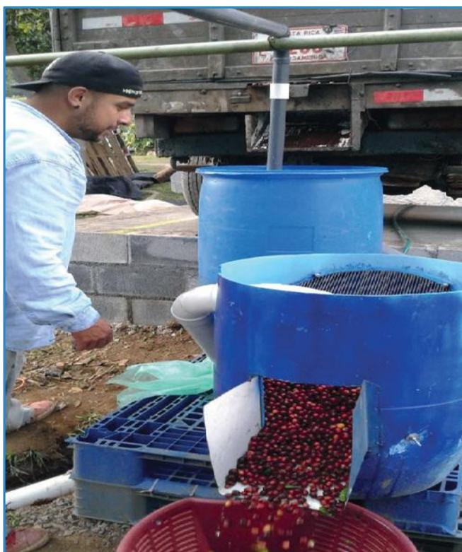
Figura 121. Paso de la fruta directamente del vehículo al sistema de estañones que hacen las funciones de despedrador, flotes, transporte de agua y fruta y recirculación del agua.
