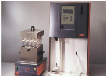
Determinación de nitrógeno
