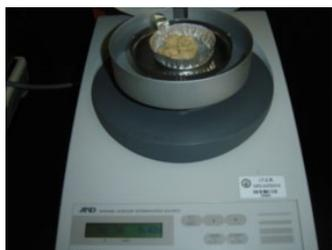
Figura 3. Lámpara de humedad
