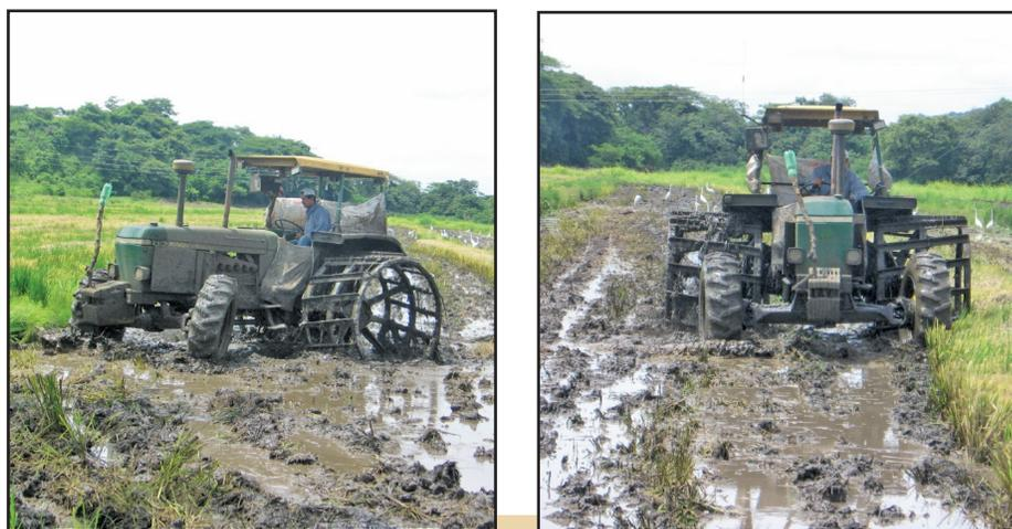
Figura 6. Adecuación de suelo mediante técnica de fangueo
