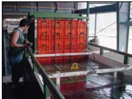
Figura 45. Tratamiento hidrotérmico del mango para control de mosca, donde se introducen las cajas con frutas en agua caliente durante un tiempo determinado Fuente: Saborío (2007).
