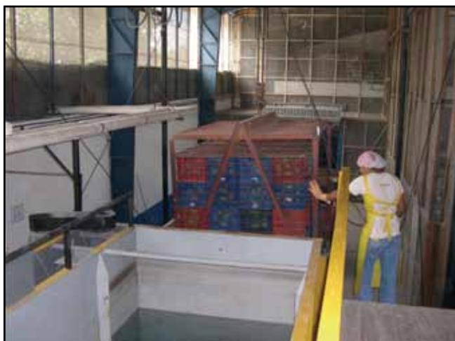
Figura 34. Manejo de la fruta de mango para el combate de moscas con el tratamiento hidrotérmico en la planta de empaque Fuente: Gamboa (2005).
